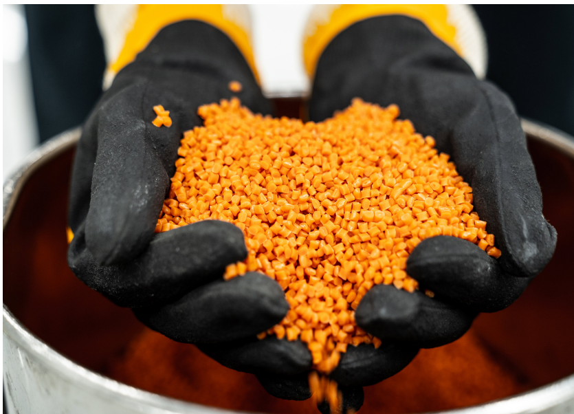
Bild 7. Für Hochvoltanwendungen werden orange eingefärbte, farbstabile Compounds benötigt. Die Farbe Orange dient in Elektrofahrzeugen zur Kennzeichnung von stromführenden Komponenten. Angeboten werden entsprechende PBT-Compounds unter anderem von Lanxess. © Lanxess
