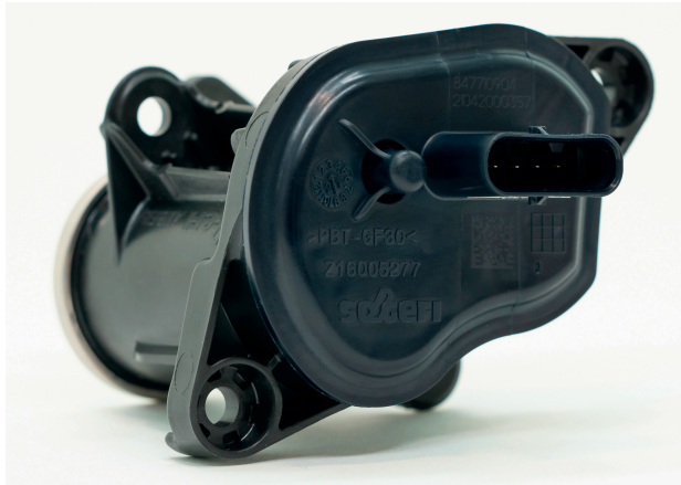
Bild 4. Der Deckel des Aktuatorgehäuses besteht aus dem lasertransparent schwarz eingefärbten Pocan B3233HRLT, die laserabsorbierende Gehäusehälfte aus Pocan B3233HR. © Lanxess
